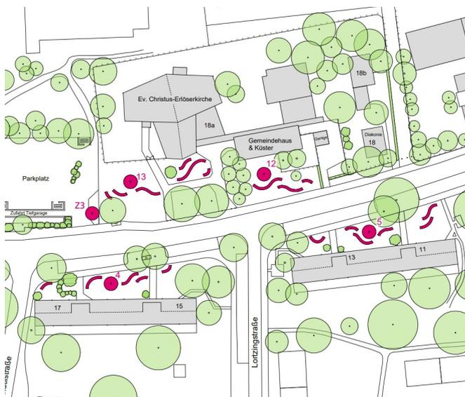
Zisternen zum nachhaltigen Erfolg der Pflanzung, zur Erhöhung der Verdunstung und zur Reduzierung des Abflusses von Regenwasser in das Mischsystem beitragen können. Die Entwicklung von ringförmigen Baumrigolen ist zudem der innovativste Teil des Projektes. Ist dieser neue Ansatz erfolgreich, können die im Rahmen der Machbarkeitsstudie und Vorplanungen ermittelten Techniken und Methoden als Vorbild für zukünftige Freiraumgestaltungen dienen.
